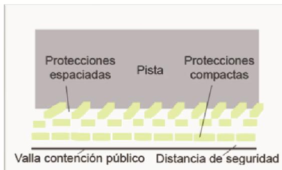
No deben de colocarse **apoyados directamente** contra un elemento inmóvil (una pared, un guarda rail, etc.). Se han dado casos de fracturas en el choque contra una bala de paja apoyada completamente en una pared.
