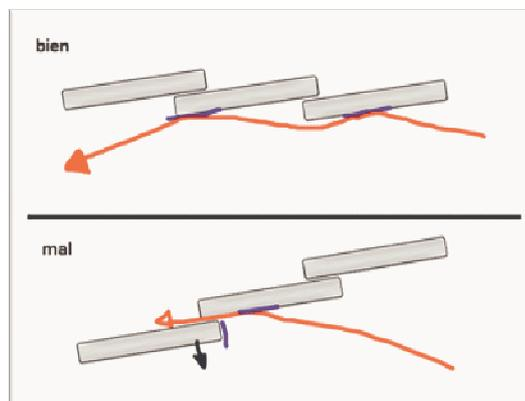
Así mismo, se deben colocar escalonadamente para permitir que un vehículo o piloto deslice de una a otra bala, sin crear esquinas donde el piloto pueda quedar encajado.
